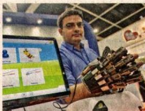
為中風康復者設計的「希望之手」，患者將手伸入機械手，想像「打開對手」，神經信號會被貼於患者手臂旁的感應器接收，啟動機械手打開。儀器目的是透過練習，令患者腦部重新學習運用手掌，現有5間醫院引入使用。（鍾林枝攝）
