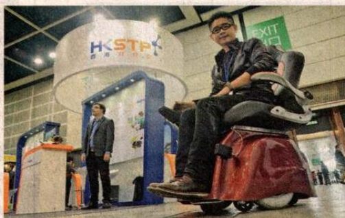
展覽中，參展商「天行健」推出一部有防撞系統的電動輪椅，透過感應器（圖中腳附近黑色物體）偵測到前方有障礙物時，會自動煞停。（鍾林枝攝）
